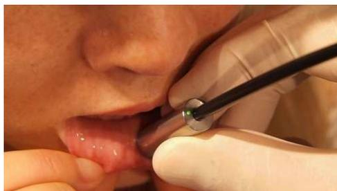
Messung der Zink-Protoporphyrin-IX-Fluoreszenz *in vivo* zur Eisenmangeldetektion. Abgebildet ist der in einer klinischen Studie evaluierte Prototyp V1 inklusive der Lichtleitfaser zur Fluoreszenzangregung und -detektion. Nach Aufsetzen der Faser auf die Unterlippe der Probandin wird eine Messung von etwa 10 Sekunden Dauer durchgeführt.
